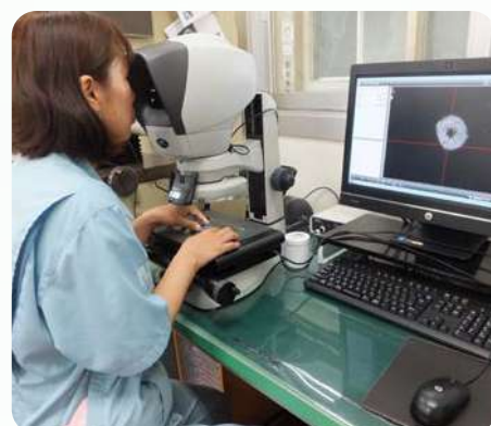
ケーブル検査
